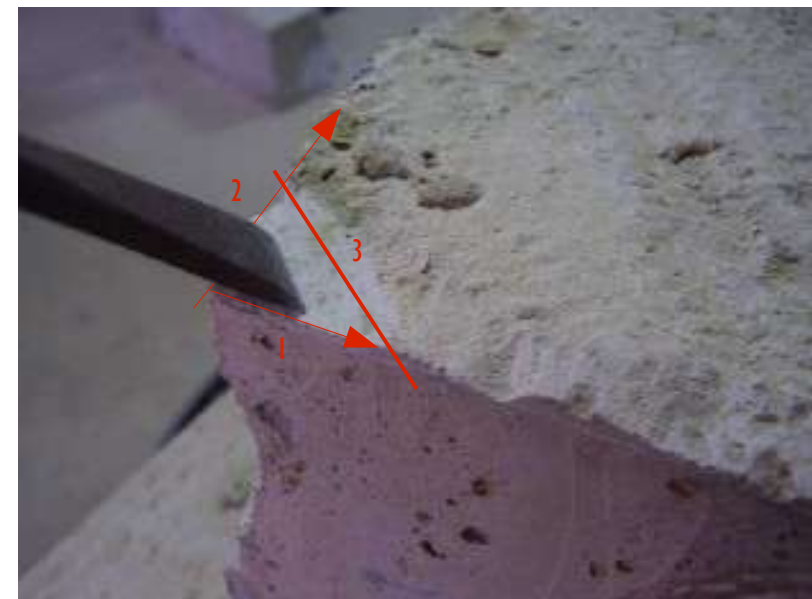
La finition des faces se fait en triangle, on suit l'arête des deux cotés et on taille à plat entre les 2 arêtes.
