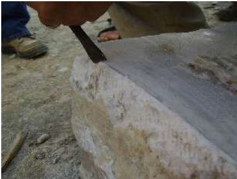
La surface étant dégrossie, reprendre une ciselure plus précise
