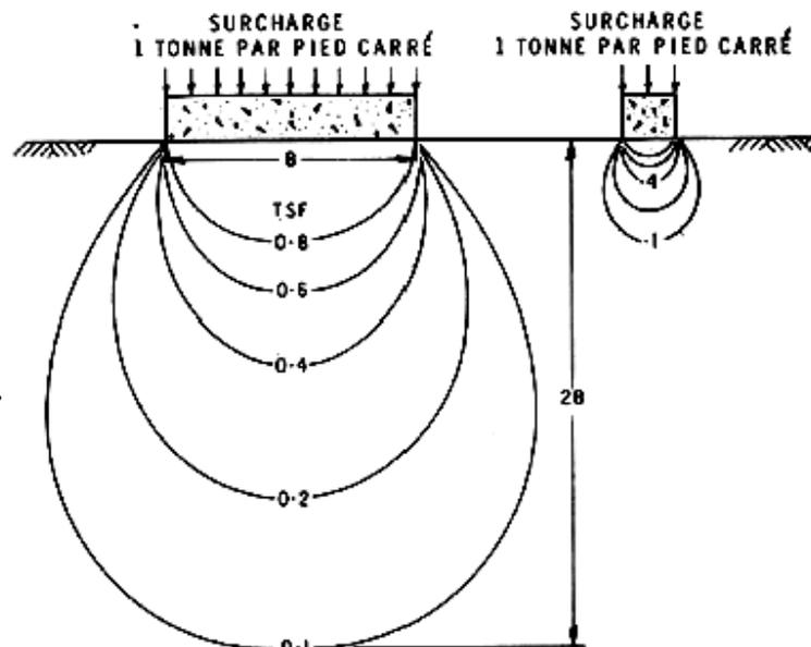
Bulbe de pression sous une fondation profonde (pieux) et sous une fondation superficielle
