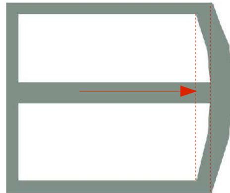
Poussée par un mur de refend. Un tassement différentiel a fait descendre le mur de refend qui se penche du côté du mur droit, entraînant une déformation de celui-ci.
