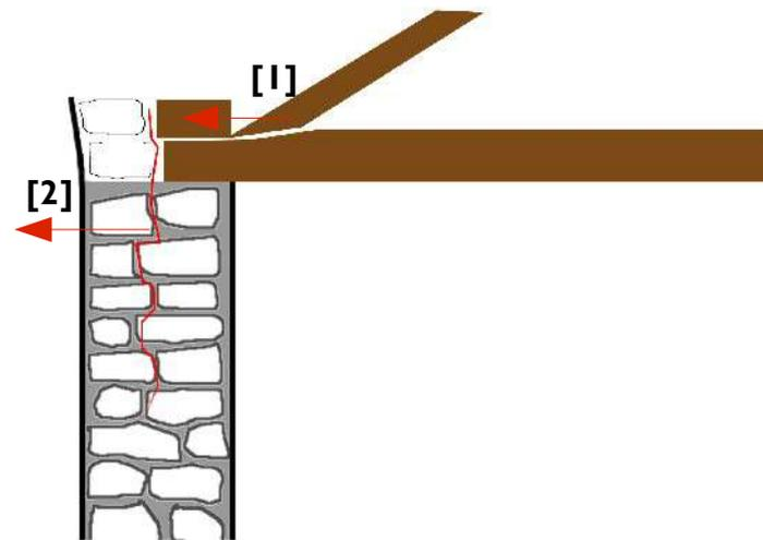
La rupture d'un embrèvement [1] entraîne une poussée sur la panne sablière qui elle même pousse sur le mur d'où une séparation des 2 parements [2]
