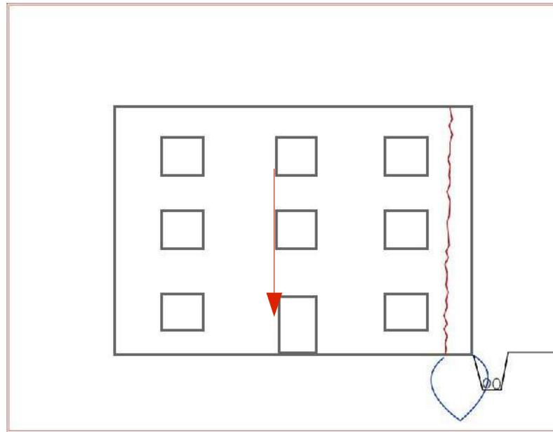
Fissure structurelle, sous son propre poids le mur s'est désolidarisé du reste du bâti, par exemple à cause du creusement d'une tranchée trop près du mur (qui coupe le bulbe de compression).
