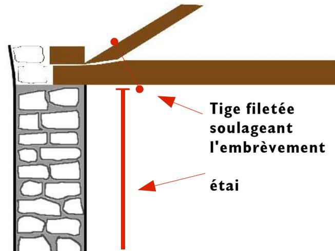
Dans un premier temps pose d'un étau pour soulager le mur du poids de la charpente. Ensuite réparation de la charpente (remplacement de la pièce ou du morceau de pièce défectueuse, ou pose d'une moise ou pose d'un tirant acier) Enfin démontage et remontage de la partie de mur abîmé
