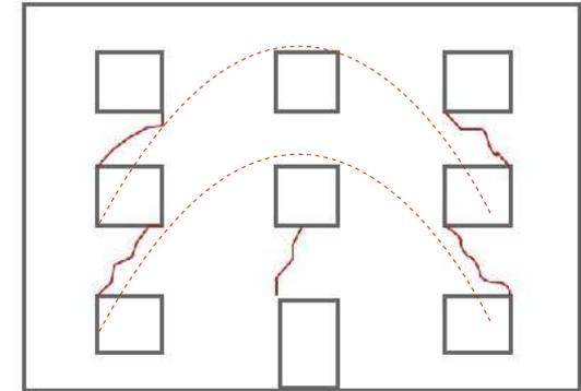
Fissure structurelle : enfoncement du sol sous le centre de la façade, création d'un arc de décharge (en pointillé).
