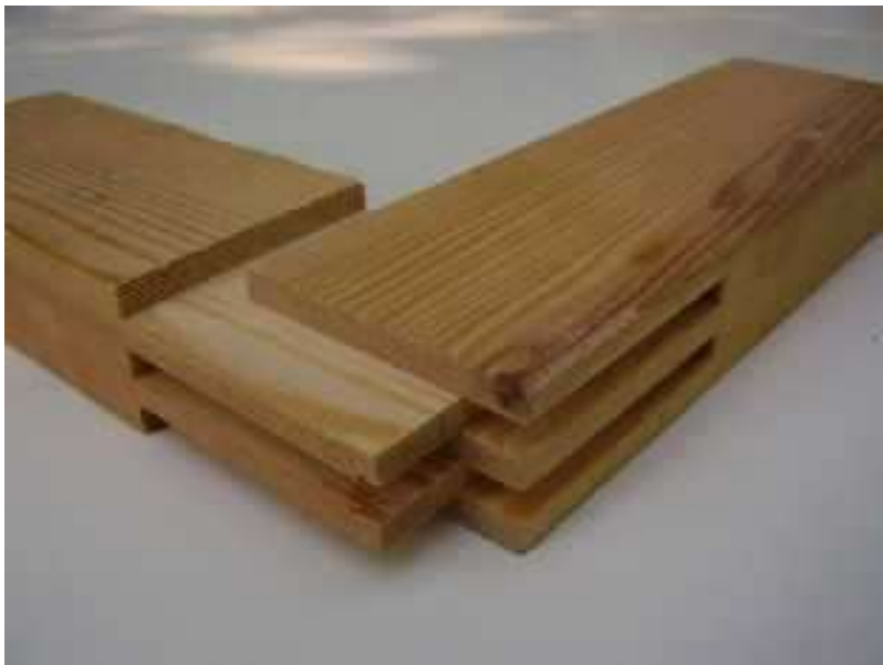
Assemblage par enfournement
