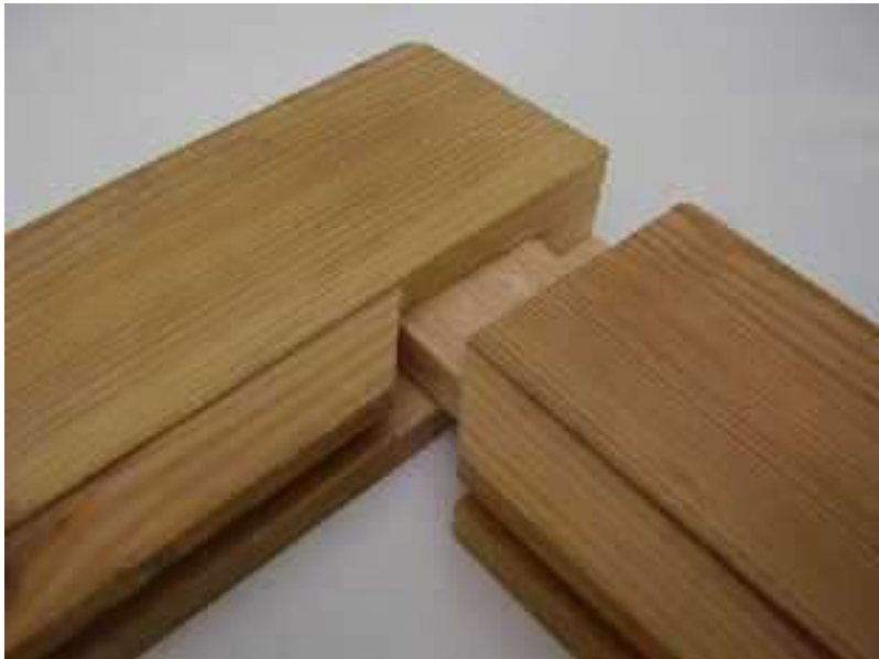
Assemblage par tenon mortaise avec rainure, moulure et coupe d'onglet.
