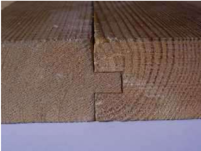
Assemblage par rainure -languette.
