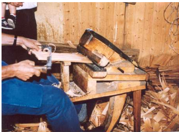
Photo 19 ) reprise des ancelles à la plane sur un banc d'âne
