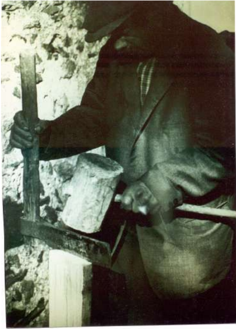
Photo 17: Le maniement du fer à ancelle ou «coutre» aussi appelé «tronchet» dans les Vosges, est toujours le même. L'outil est frappé à l'aide d'un maillet généralement en frêne.
