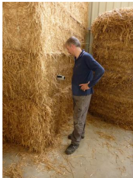
Contrôle de l'humidité < 20%
