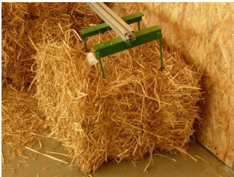
Numérotation et étiquetage des bottes de paille après contrôle du gabarit et du poids
